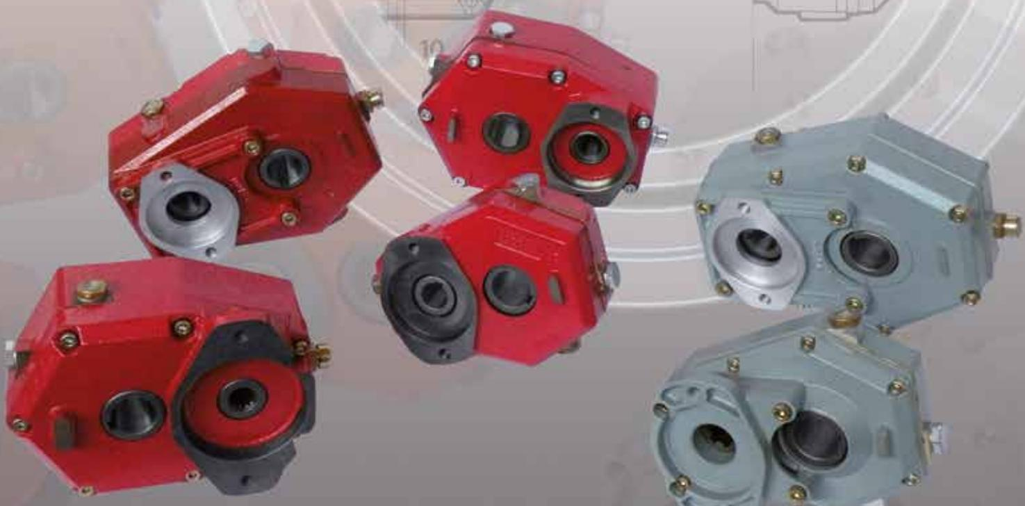
I riduttori vengono impiegati per il collegamento di motori idraulici su macchine agricole semoventi, macchine movimento terra e settore marino. Il regime d'uscita dei riduttori è di 200 g/1° per cui il regime d'esercizio dei motori idraulici viene rapportato adeguatamente, sempre che il regime d'entrata non superi i 3000 g/1°.
